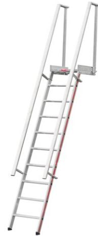
**Gewicht:** 24,5 kg**Ausladung:** 1,86 m**Standhöhe:** 3,47 m**Arbeitshöhe:** 5,47 m**Leiterlänge:** 3,7 m**Sprossen/Stufen:** 15**Trittform:** Stufen**Hersteller:** Hymer**Material:** Aluminium**Kategorie:** Stufenaufstieg**Gewicht:** 24,5 kg**Tragkraft:** 150 kg
