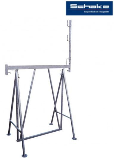
**Gewicht:** 41.82 kg**Senkrechte Höhe:** 2,00 m**Hersteller:** Schake**Material:** Stahl**Kategorie:** Gerüstböcke**Eigengewicht:** 44 kg**Tragkraft:** 900 kg**Beschichtung:** verzinkt
