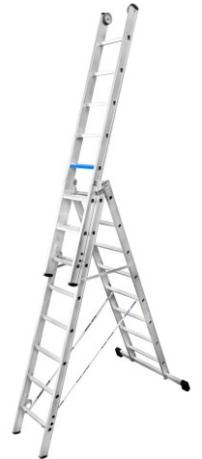
**Standhöhe:** 4,70 m**Typ:** ERGO Plus**Arbeitshöhe:** 6,70 m**Sprossen/Stufen:** 3x8**Trittform:** Stufen**Hersteller:** Iller Leiter**Teilbarkeit:** 3x**Material:** Aluminium**Kategorie:** Mehrzweckleiter
